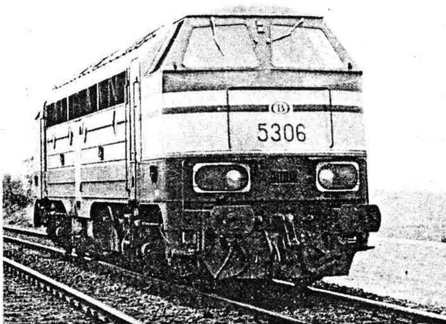
Ces deux photos montrent la locomotive n° 5306 après et avant la transformation des cabines de conduite et des avant-corps. Photos Y. Steenebruggen.
